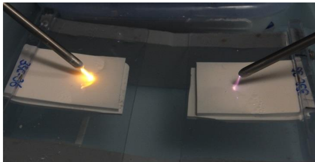
図1 SiR試料に発生させたアーク放電
