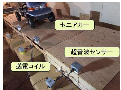
図1 走行中車両への送電システム
