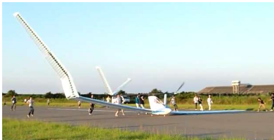
Picture.5 交流飛行会で桁が折れた瞬間
