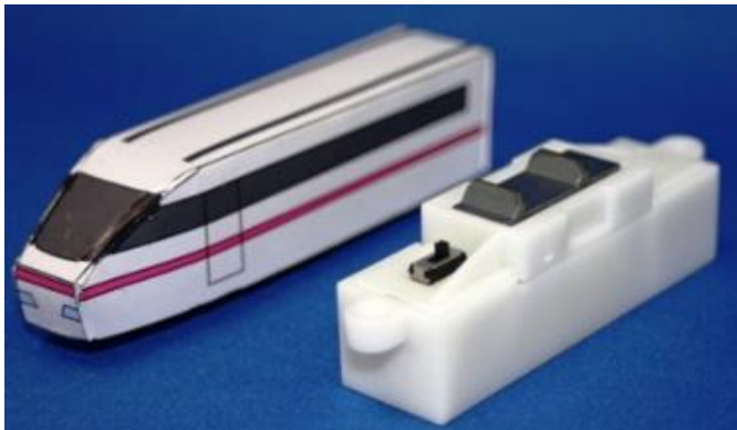
車輪がないのに動く物体 超音波モーター
