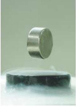
超伝導体による磁石の浮上実験
